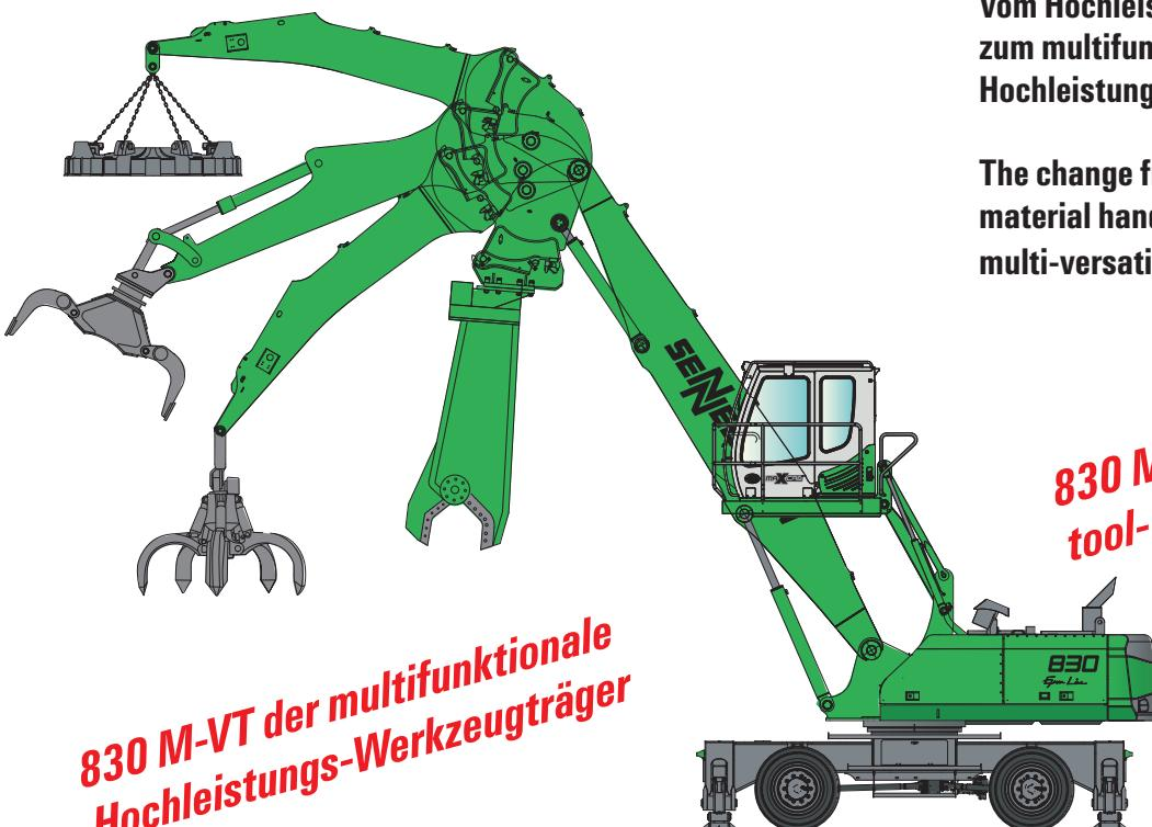
Vom Hochleistungs-Umschlaggerät zum multifunktionalem Hochleistungs-Werkzeugträger
